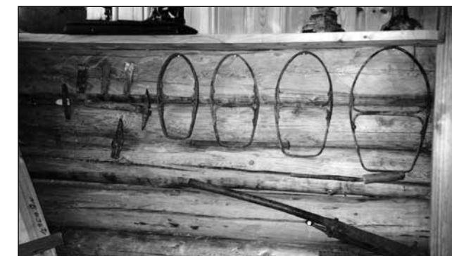
"Maler" som ble brukt til å forme størrelsen på taksteinen.
