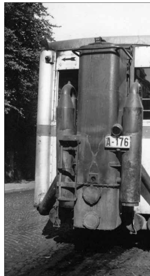
Generator montert på buss.
